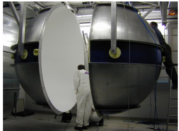
Fig. 2: Installation of a 2.5 m integrating sphere at the Physikalisch-Technische Bundesanstalt PTB
